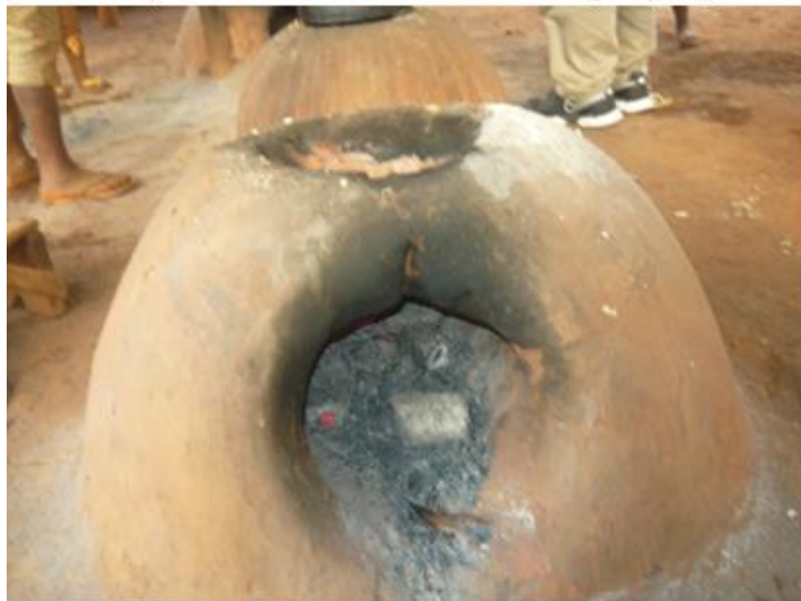
Photo 6a : Illustration du faible rendement des foyers dû à leur design; un grand volume de la chambre de combustion et une grande taille de la porte d'alimentation, camp kinama.
