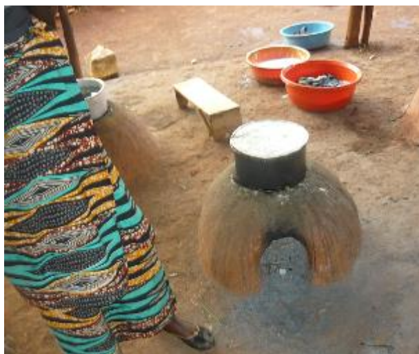
Photo 7a : Inefficacité du foyer dû à la hauteur exagérée entre la marmite et le foyer, camp kinama
